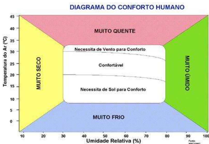
Figura 1: Diagrama do conforto humano com base na temperatura e umidade relativa do ar
