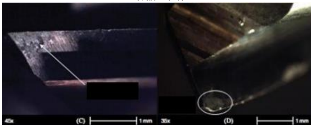
Figura 7. Ranhuras típicas de abrasão observadas nas fresas de metal duro sem revestimento
