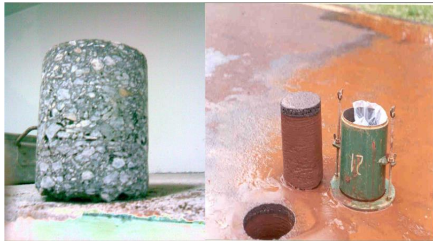
Figura 2 - Compactação com asfalto e compactação utilizando a enzima Earthzyme.
