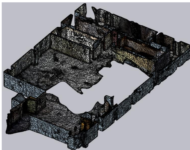
Figura 5: Primeiro pavimento da edificação, imagem 3D como dados brutos, nuvem de pontos.
