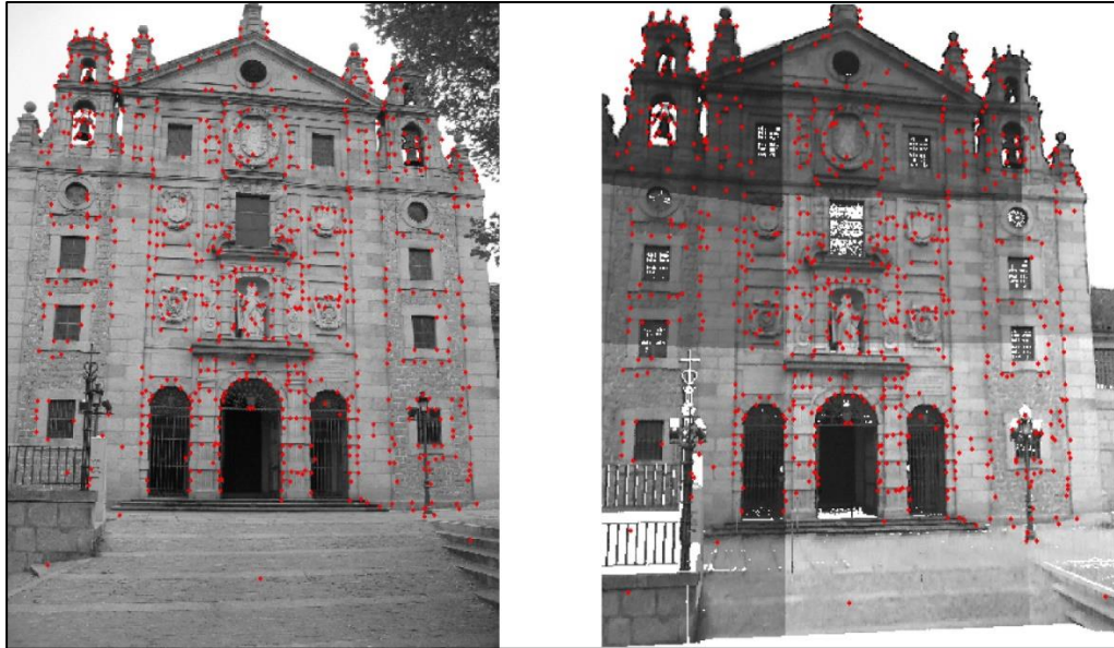
Figura 1: Correspondência robusto. À esquerda: imagem da câmera. Direita: Imagem de alcance (Aguilera et al. , 2009).
