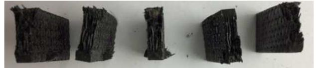
**Figura 17 - Superfície de fratura para a configuração mista dos corpos de prova.**
