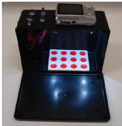
**Figura 1** - Dispositivo utilizado para aquisição das imagens digitais.
