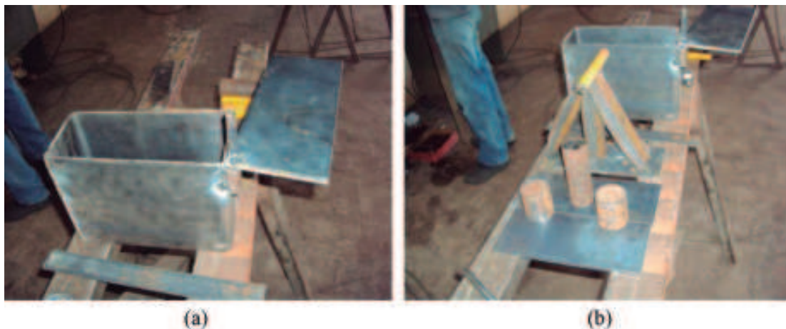
Figura 1 - Esquema de montagem da prensa para tijolos ecológicos: (a) caixa de prensagem e (b) mão francesa.
