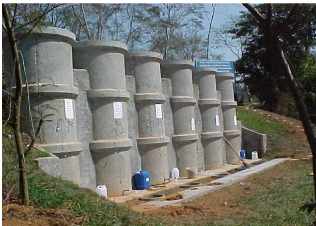
Figura 1. Vista geral das colunas preenchidas com resíduos sólidos urbano
