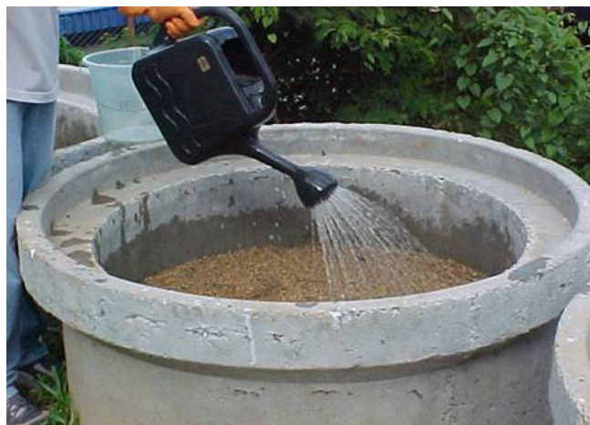
Figura 2. Sistema de recirculação e detalhe da lâmina de percolado formada sobre a coluna de resíduos sólidos urbano
