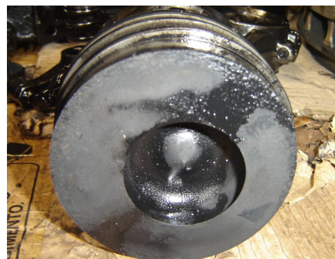
Figura 8. Situação do pistão no tratamento OV50/T90.
