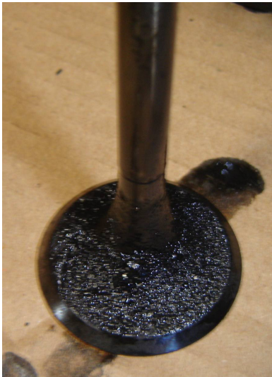
Figura 1. Deposição de resíduos na válvula de admissão no tratamento OV5/Tamb.
