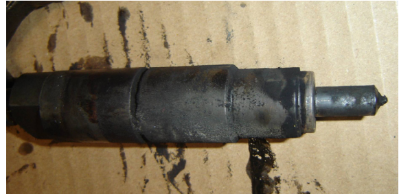
Figura 3. Deposição de resíduos no bico injetor no tratamento OV05/Tamb.
