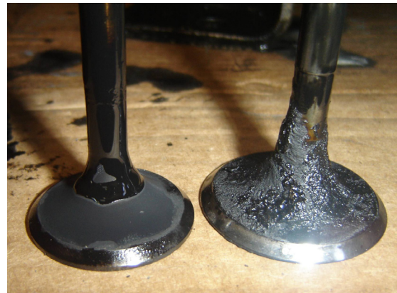
Figura 4. Depósito na válvula de admissão no tratamento OV0/Tamb
