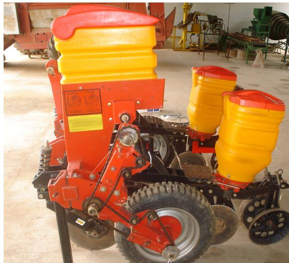
**Figura 1.** Semeadora-adubadora utilizada no experimento
