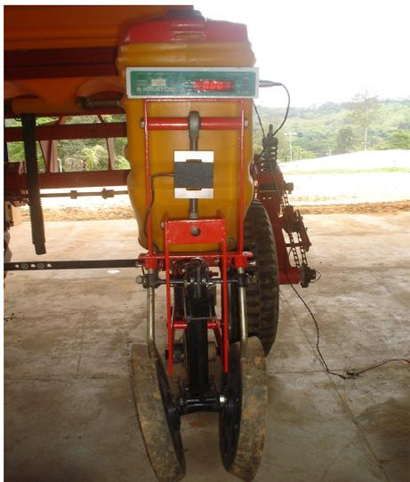
**Figura 2.** Visor conectado à célula de carga para a obtenção das cargas aplicadas pelas rodas compactadoras
