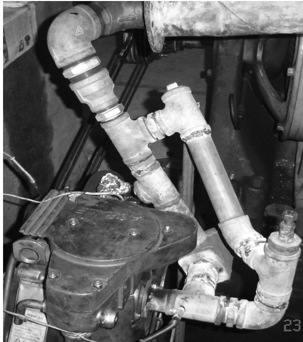
Figura 1. Sistema de aquecimento de combustível desenvolvido para motor estacionário Agrale, modelo M90.
