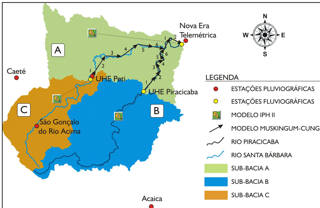
Figura 1 – Esquema do segundo modelo hidrológico, sub-bacias discretizadas, estações utilizadas no trabalho e rios Piracicaba e Santa Bárbara.
